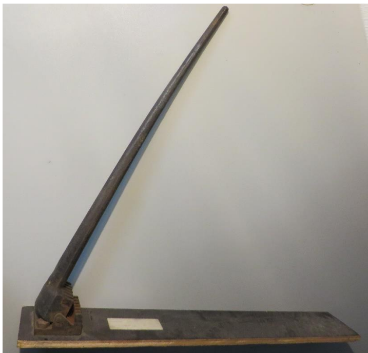
Afb.77. Het apparaat uit de 30er jaren om gebruikte nagels terug te rechte. Het ultieme bewijs dat het uurloon extreem laag was.
