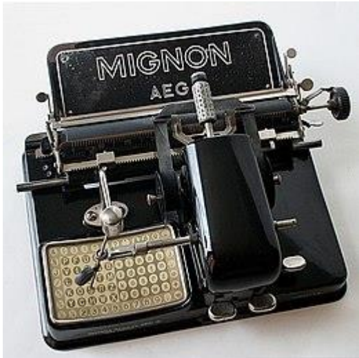
Afb. 79f. Een éénvinger-typmachine Mignon zoals Jan Steyfkens er een kocht rond 1933. De letter wordt met de linkerhand via een mechanische pen gekozen op het scherm met alle lettertekens. Met de rechterhand wordt daarna de druktoets bediend.
