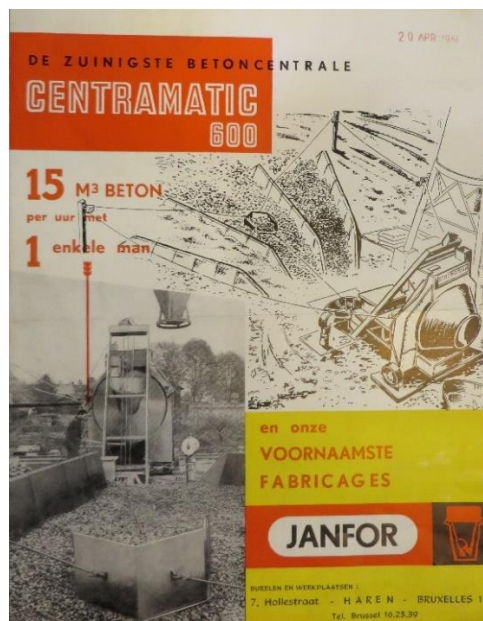
Afb. 399. De verkoopbrochure van de betoncentrale Janfor, welke aan de autostradebruggen werd gebruikt in de jaren 1960. De folder vermeldt een capaciteit van 15 m 3 per uur. Zie ook afb. 345 en 346.
