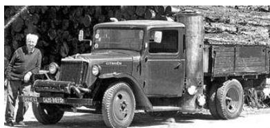
Afb. 50. Voorbeeld van een vrachtwagen uitgerust met een houtgasketel.
