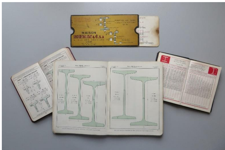
Afb.76. Boeken en berekeningsschuiftabel van de stalen liggers die in vele bouwwerken werden gebruikt.
