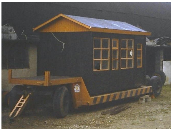
Afb. 443. Een extra werfkantoor (een zelfgebouwde variatie op de bureelcontainer) staat klaar om naar de werf vervoerd te worden.
