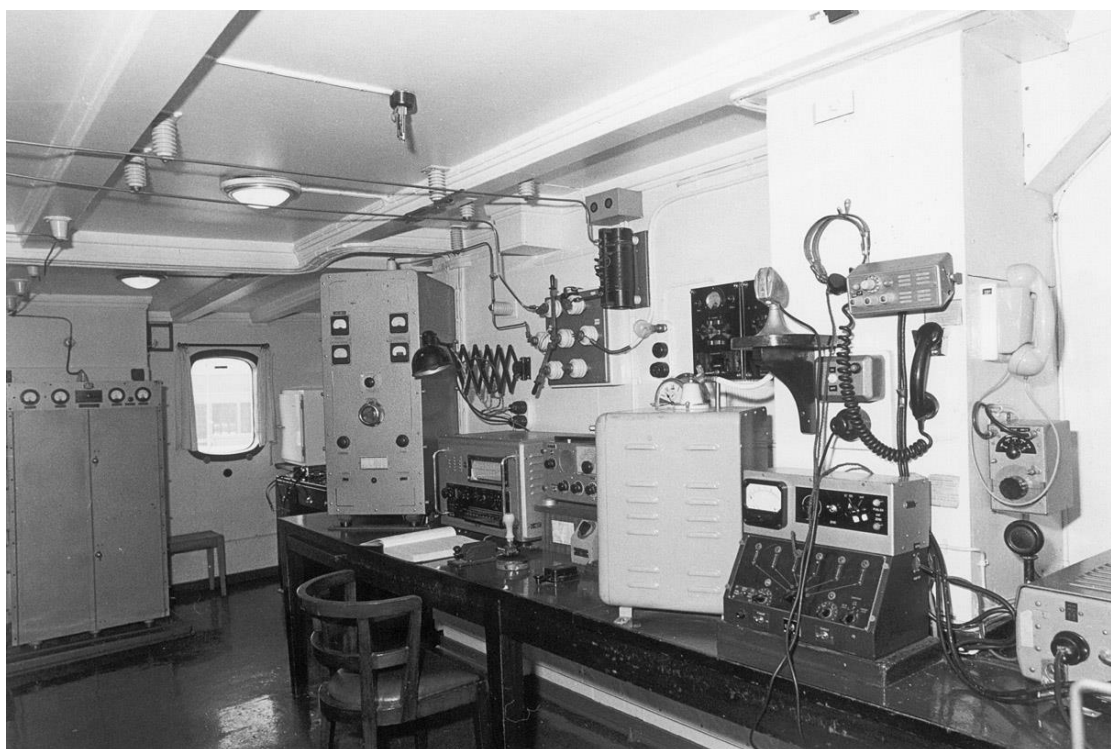
Koning Albert: radiokamer met links de telefoniezender EF125. Op de tafel links de hoofdtelegrafiezender 8010, daarnaast de hoofdtelegrafieontvanger HAGENUK UE12, (die de 358X had vervangen) verder, gedeeltelijk zichtbaar, de hulptelegrafieontvanger RSTA114. Verder de hulptelegrafiezender (de zgn. noodzender) IMR31 en de kleine bedieningsdoos voor het starten van de omvormer. Naast de IMR31 de bedieningsdoos van de EF125 met opgebouwde unit voor duplex VHF. Uiterst rechts de DUPLEX-VHF. Op de wand boven de UE12 de antenne-omschakelaar met verlengspoel voor de hulpantenne. Daarnaast het laadsysteem voor de noodbatterij. Boven de bedieningsdoos van de EF125 staat de bedieningsdoos met microfoon van de DUPLEX-VHF. Men bemerkt ook de duplex-filter voor de telefonieontvanger en daar vlak onder de micro van de EF125.
