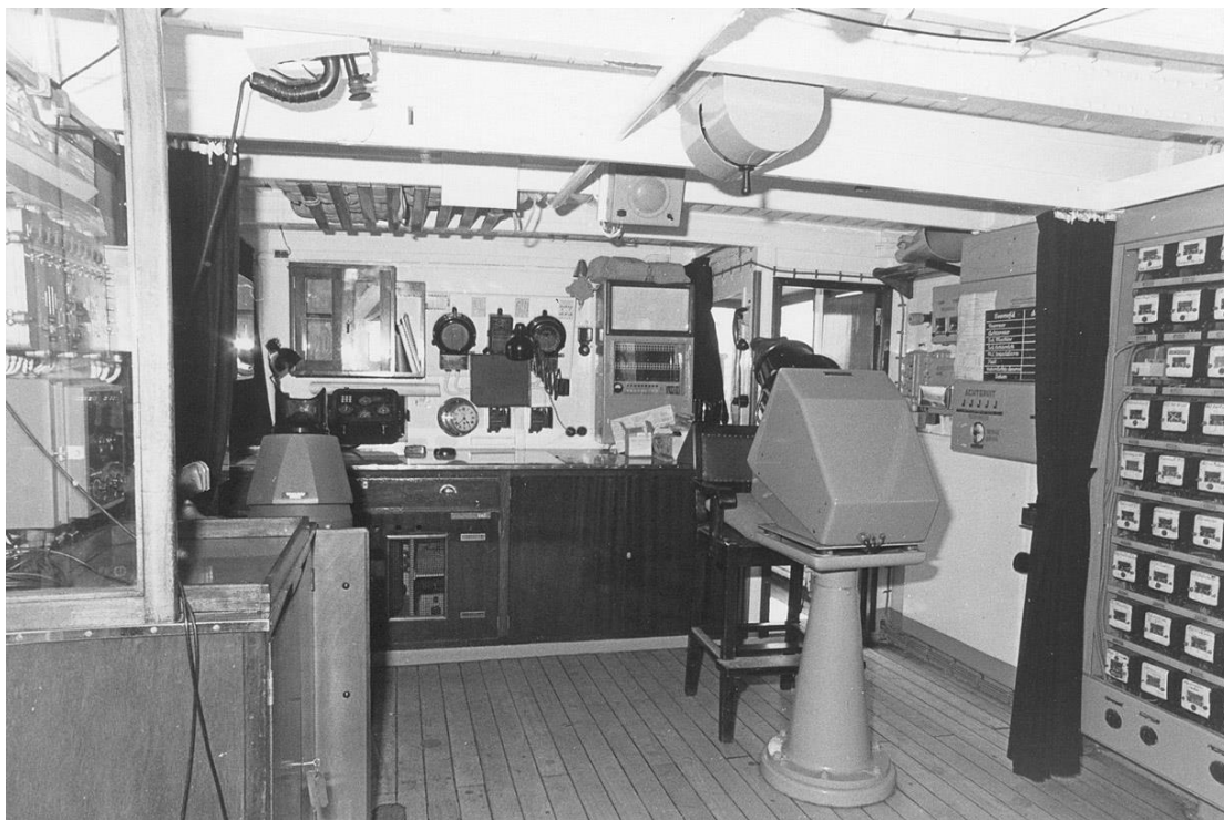
Koning Albert: stuurhuis(achterzijde). Uiterst links: de mastercommunicator met onderaan de versterker. Op de kaartentafel links het DECCA-navigatorsysteem. In het midden de Chernikoff-log voor het meten van de snelheid en de afgelegde afstand.
