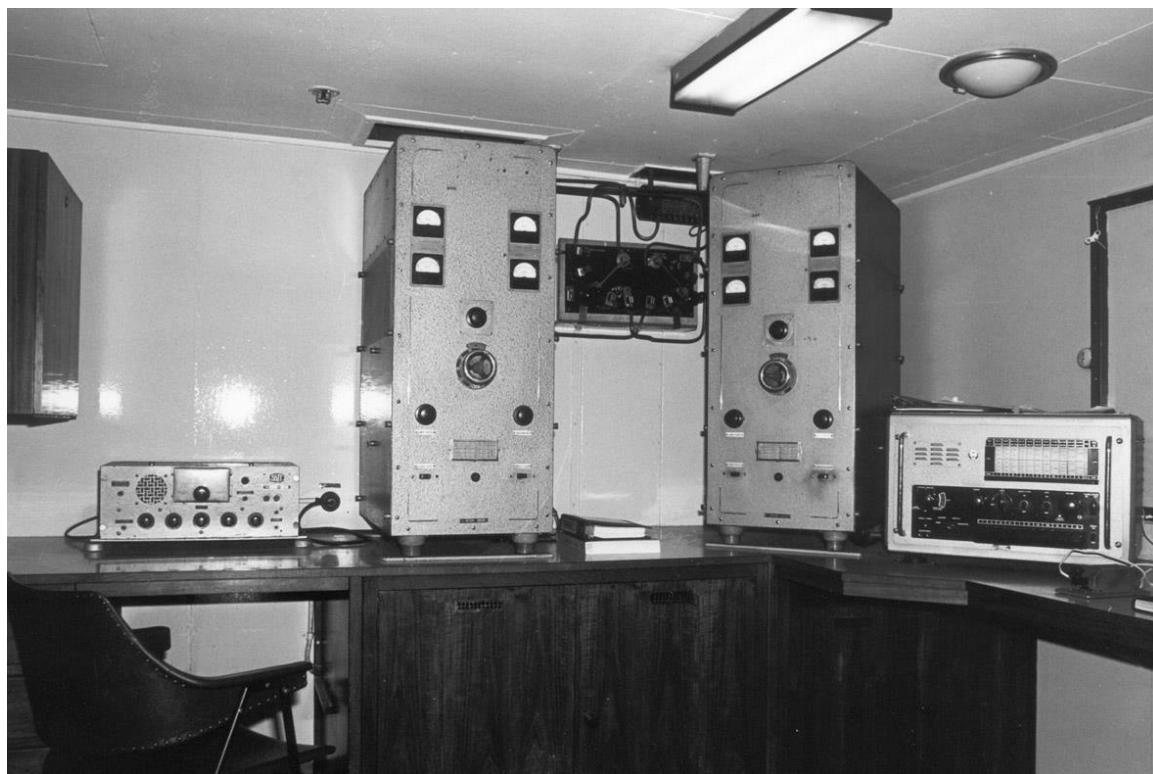
Radio-installatie van de Koningin Fabiola (deel). Van l.n.r.: hulptelegrafie-ontvanger RSTA114, hulptelegrafiezender 8010, de hoofdtelegrafiezender 8010 en de hoofdtelegrafie-ontvanger Hagenuk UE12 (oorspronkelijk stond er een RSTR114 op 220VDC).
