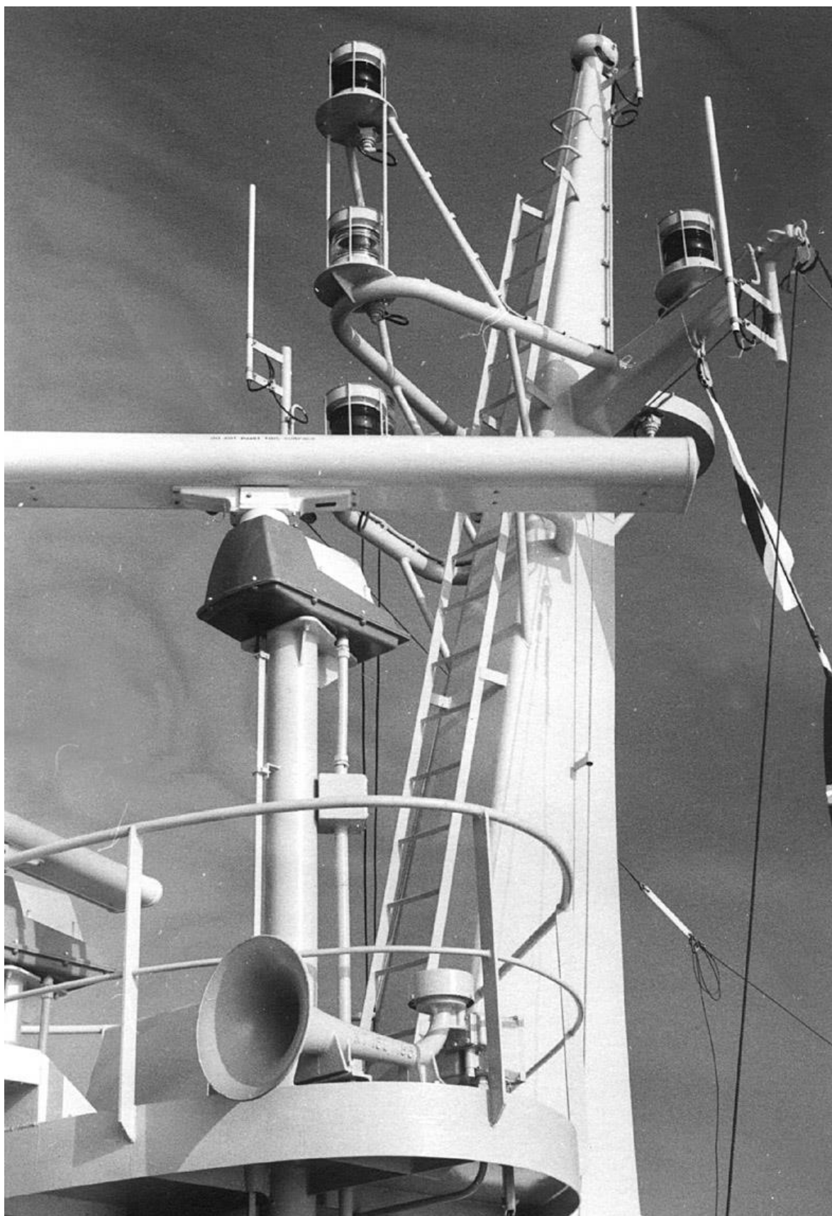
Prince Laurent Juni 1974. Er waren drie VHF-antennes gemonteerd op de voormast. In het midden de radarantenne van de anti-collisionradar merk DECCA type AC1229.
