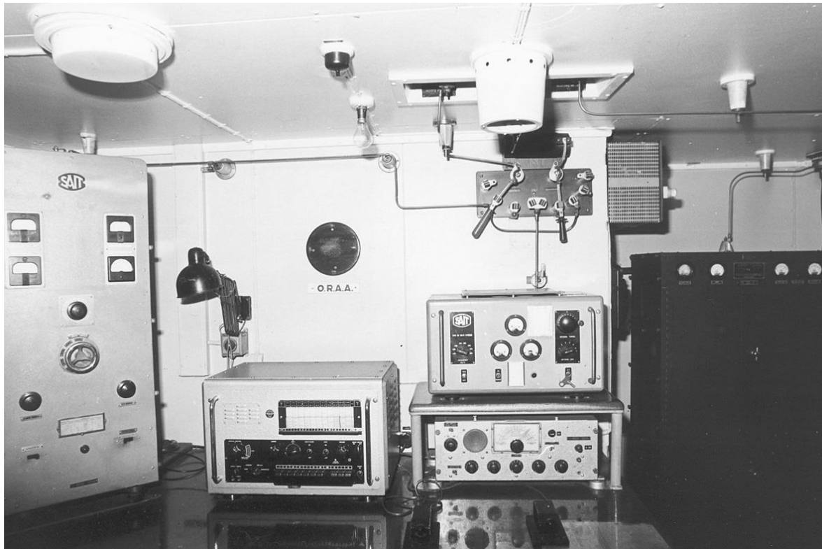
De radiokamer van de Prinses Josephine Charlotte in 1976. Van l.n.r. de hoofdtelegrafiezender 8010C, hoofdontvanger HAGENUK type UE12, hulptelegrafieontvanger RSTA114 met boven de hulptelegrafiezender SAIT type ES100 (verving de 8003). Uiterst rechts de telefoniezender EF125.
