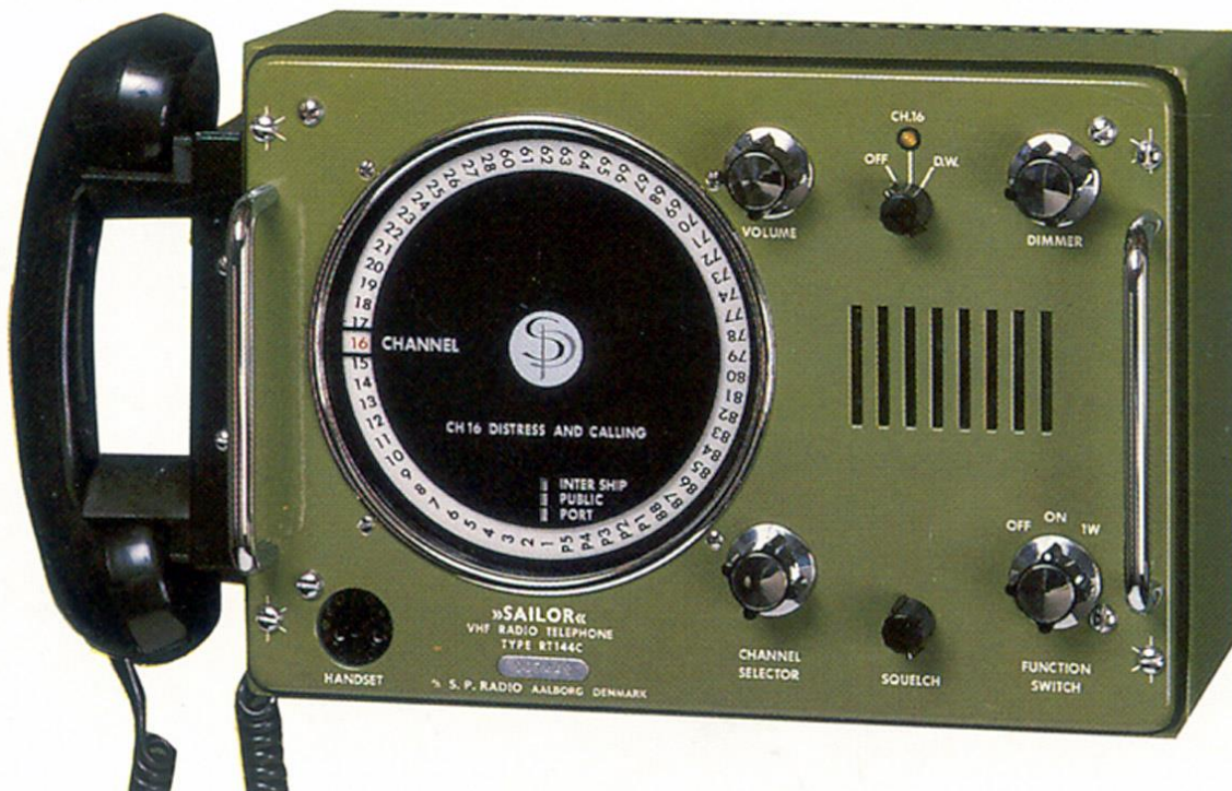
De Jetfoils hadden twee VHF-zenderontvangers aan boord: een Triton 55/75 mod. D5 en een SAILOR RT144C
