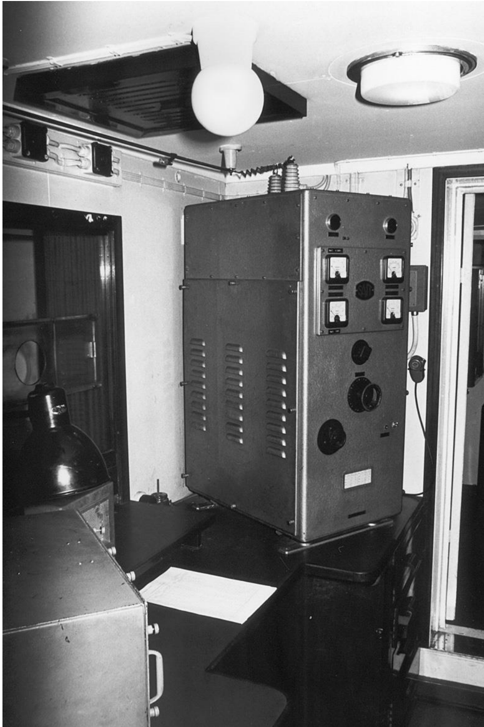
Radiokamer van de Koningin Elisabeth (deel). Rechts de hoofdtelegrafiezender EG156. De toestellen waren van hetzelfde type als aan boord van de Roi Leopold III. De schikking was wel anders. De VHF-duplexzenderontvanger (met radiobuizen) 8302 werd inmiddels in 1972 vervangen door een PYE T30FM/R17FM (met transistors).
