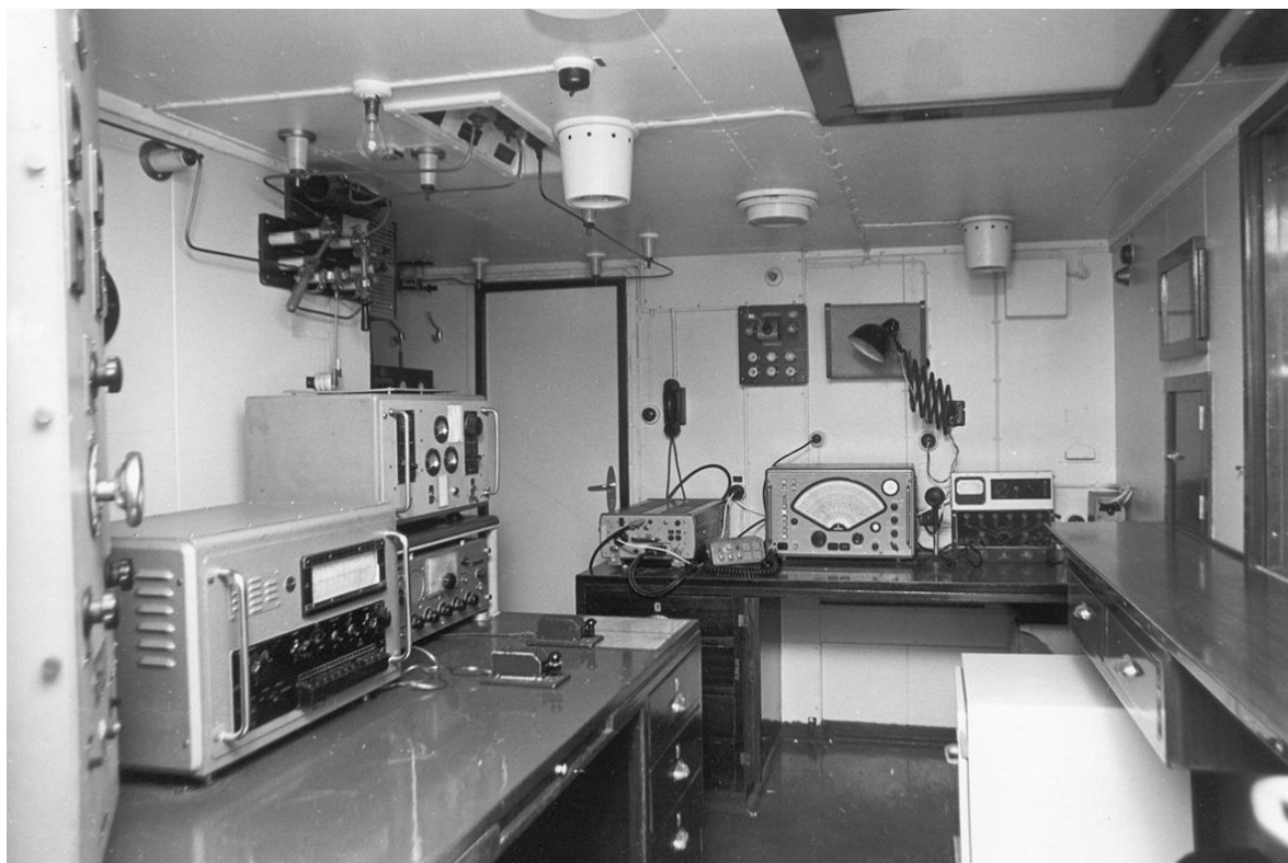
Radiokamer van ORAA (vervolg). Midden van l.n.r. de duplex VHF-radiotelefoniezender-ontvanger PYE8302 met bedieningsdoos, de telefonieontvanger voor duplex op de middengolven SIEMENS 745E, microfoon en bedieningsdoos voor de EF125 met bovenop de omschakelunit 8302-EF125, uiterst rechts de 'rejector' (duplex-filter voor de 745E). Op de wand: schakelbord voor het starten van de motoralternator voor voeding van de telefonie-installaties.
