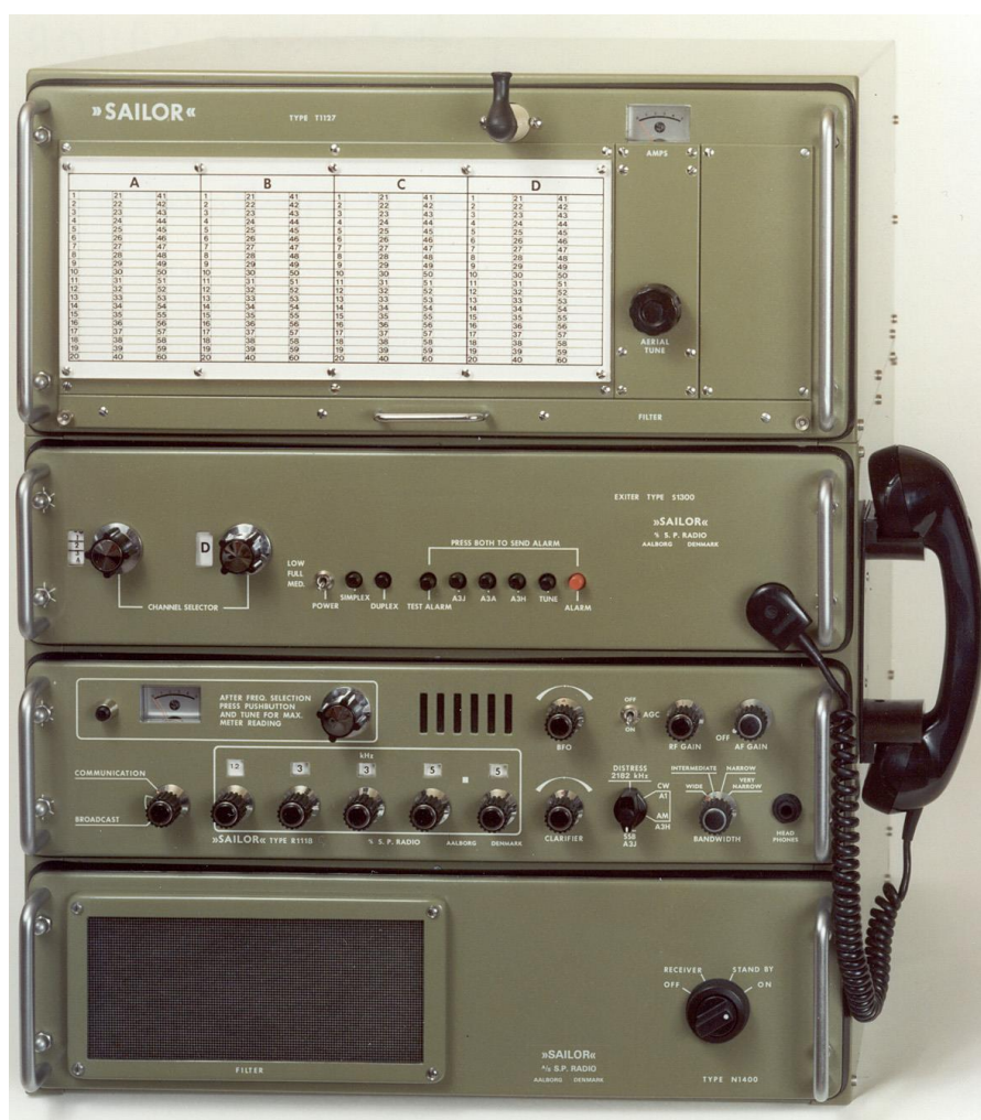
SSB-zenderontvanger van het merk SAILOR zoals ooit geïnstalleerd aan boord van het opleidingsschip Commandant Fourcault. Van boven naar onder: de zender, stuurtrappen van de zender met telefonie auto-alarminrichting, de ontvanger en onderaan de voeding.
