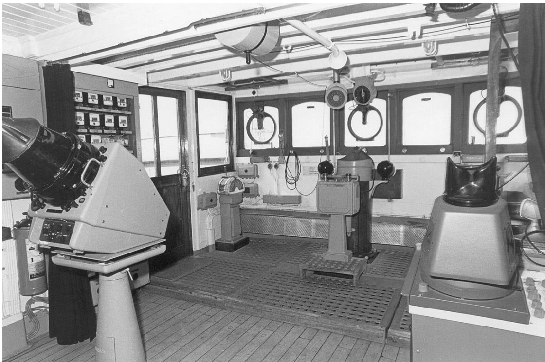
Koning Albert: stuurhuis (voorzijde). Er is geen stuurwiel: het roer werd bediend door een elektrisch systeem met twee drukknoppen.
