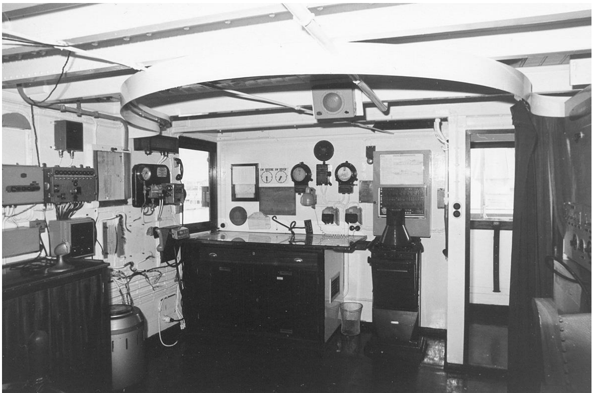
Prinses Josephine Charlotte: stuurhuis (achterzijde). Links de megafoon voor een rechtstreekse verbinding met de machinekamer. Daarnaast de mastercommunicator met de getransistoriseerde versterker TELEVIC.
