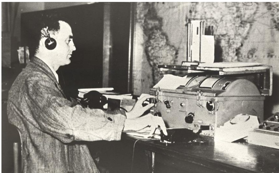
Stene 1955: Operatorstand middengolftelegrafie met ontvanger TELEFUNKEN 381H. De mailboten kwamen zich hier aanmelden met hun telegrammen en ook met de gespreksaanvragen voor duplextelefonie.
