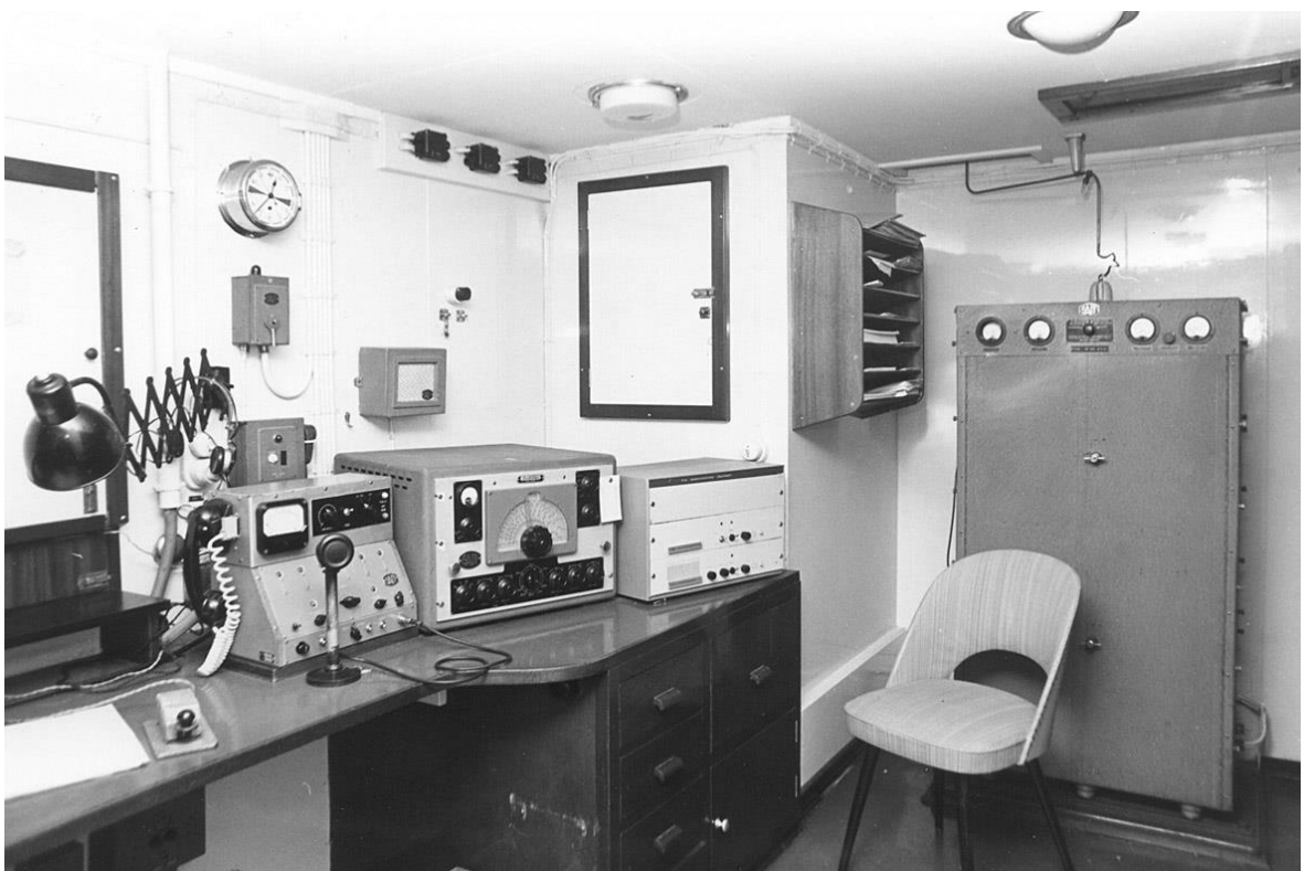
Artevelde: radiokamer (vervolg). Van l.n.r.: loket, bedieningsdoos EF125 + VHF, telefonie-ontvanger R50M, duplex-vhf-zenderontvanger en rechts de telefoniezender EF125.
