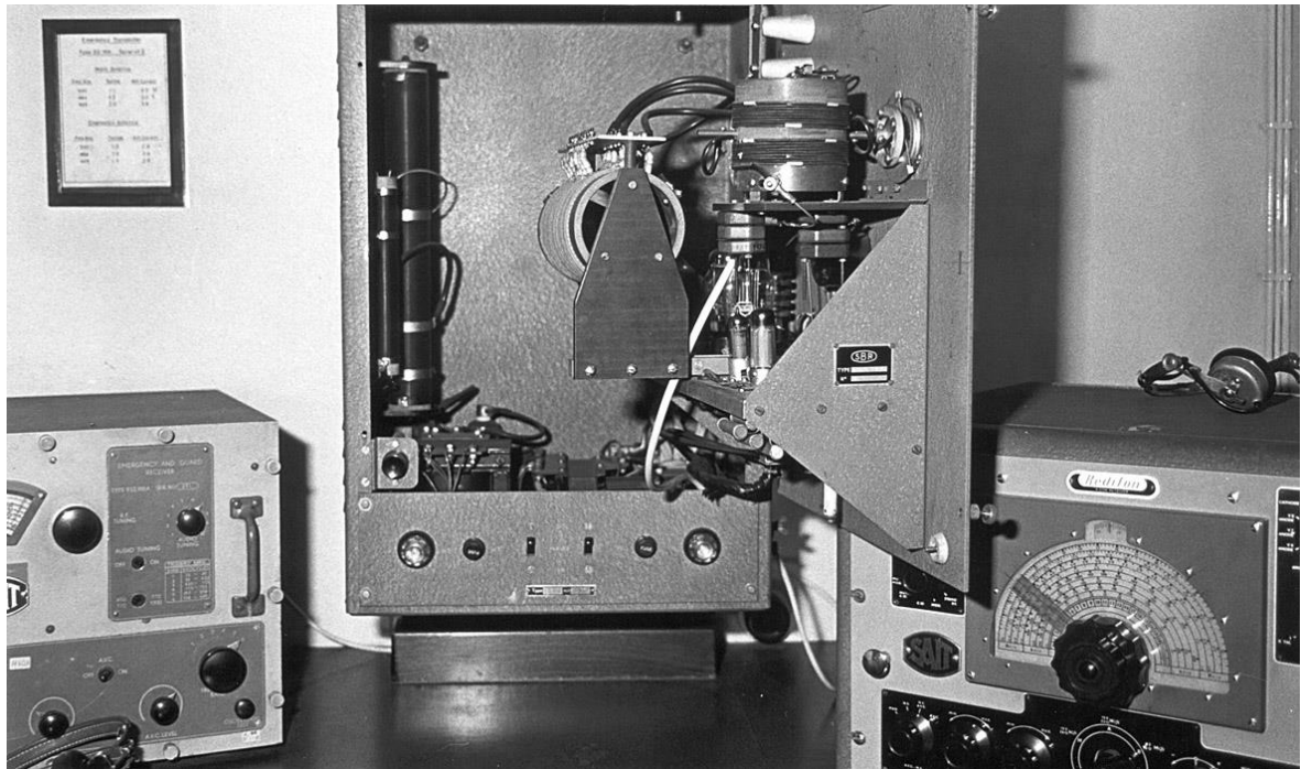
Reine Astrid (nr.1): Links de hulptelegrafie-ontvanger. In het midden de hulptelegrafiezender (SBR) type EG166. Rechts de telefonie-ontvanger Redifon R50M.
