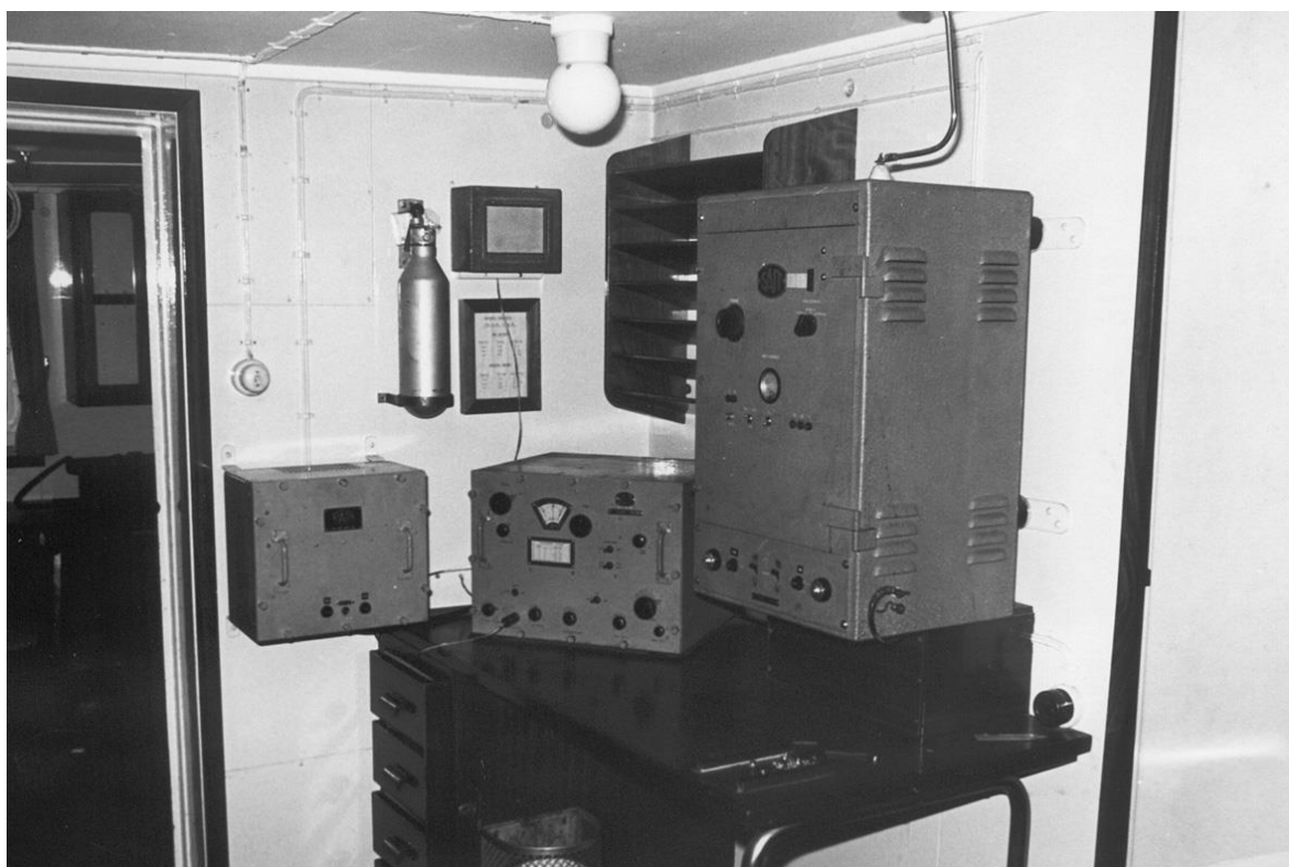
Radio-installatie van de Roi Leopold III (vervolg). Aan de wand de voedingseenheid PSA115 voor de hulptelegrafie-ontvanger. Op de tafel de hulptelegrafie-ontvanger RST155 en de hulptelegrafiezender (SBR) type EG166.
