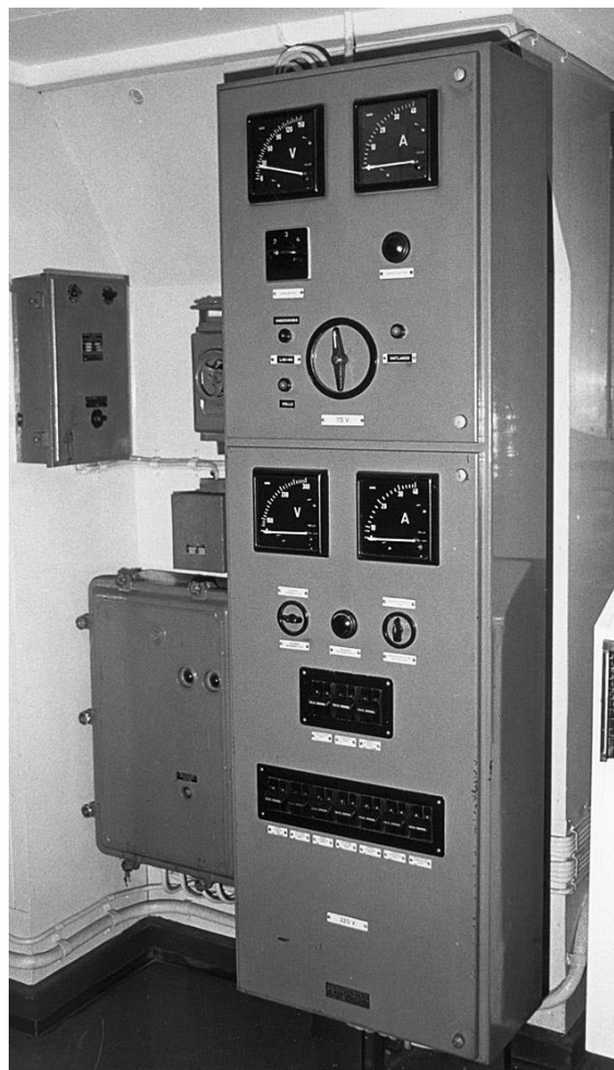
Reine Astrid (nr.1): Links de hulptelegrafie-ontvanger. In het midden de hulptelegrafiezender (SBR) type EG166. Rechts de telefonie-ontvanger Redifon R50M.
