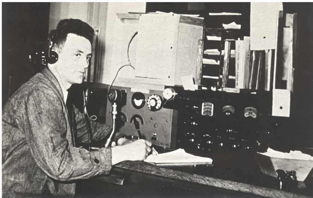
Stene 1955: Telefonie-operatorstand met ontvanger RCA CR91. Hier werden o.m. de duplextelefoniegesprekken met de mailboten doorverbonden met de abo's van het telefoonnet. Operator: Albert Bonte.
