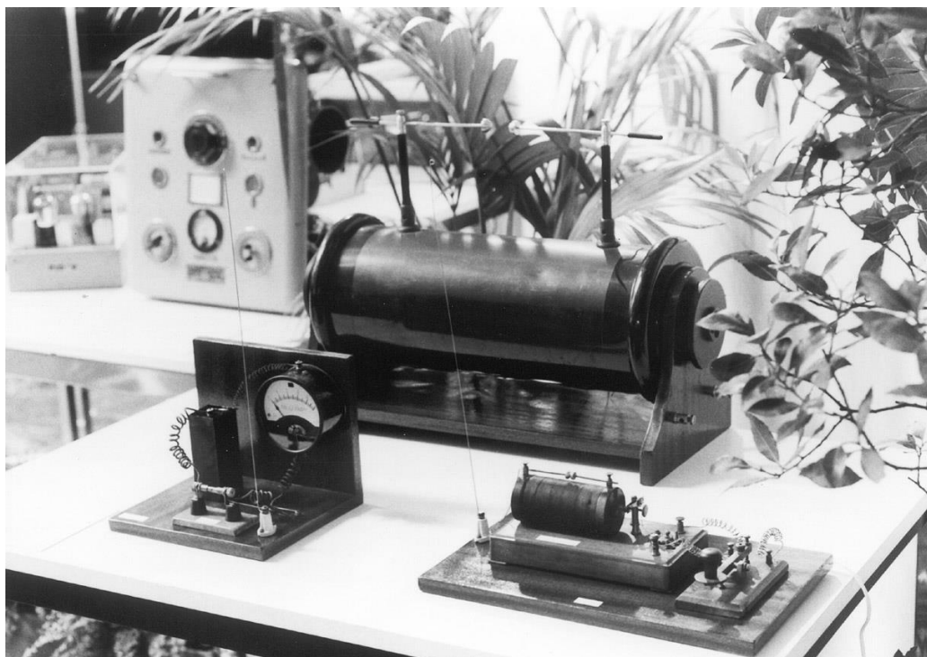
Vooran links de coherer met batterij, meettoestel en antenne, daarnaast een kleine Ruhmkorffvonkenzender. Op de achtergrond een grote Ruhmkorffbobijn uit de tijd van de eerste radiotelegrafiezenders.
