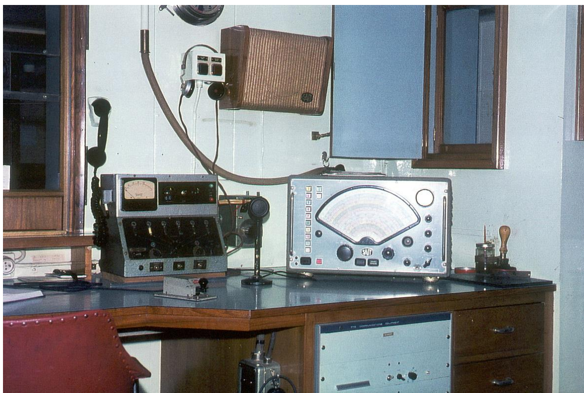
Koningin Fabiola: radiokamer (vervolg). Naast de bedieningsapparatuur voor duplextelefonie staat de telefonie-ontvanger SIEMENS 745E. Onder de tafel de VHF duplex-zenderontvanger PYE T30FM/R17FM die de oorspronkelijke PYE 8302 had vervangen.
