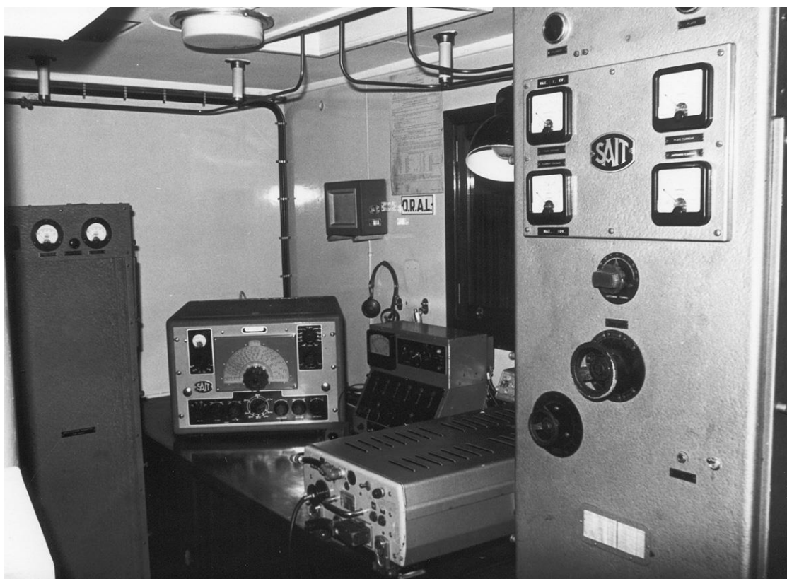
Radio-installatie van de Roi Leopold III (vervolg). Links: telefoniezender EF125. Op de tafel van links naar rechts de telefonie-ontvanger Redifon R50M; bedieningsdoos voor de telefoniezender EF125 met omschakelsysteem voor duplex-telefonie op VHF; duplex VHF-zenderontvanger PYE type 8302 (gemonteerd in 1960); hoofdtelegrafiezender EG156 (SBR).
