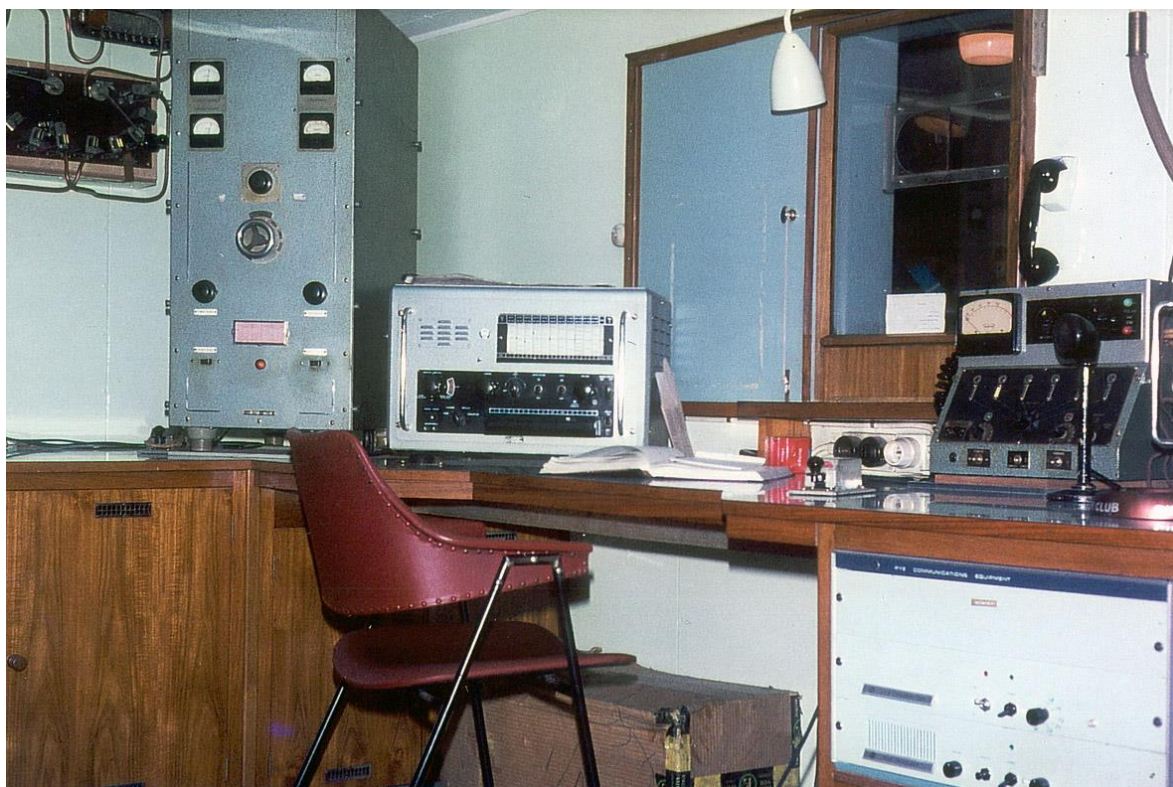
Koningin Fabiola: radiokamer (vervolg). Van l.n.r.: hoofdtelegrafiezender 8010, de hoofdtelegrafie-ontvanger UE12 en de bedieningsdoos duplextelefonie met microfoon.
