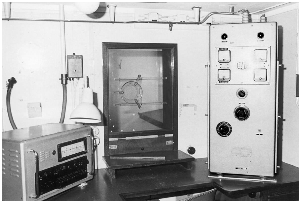
Reine Astrid (nr.1): Radiokamer (deel) links de hoofd-telegrafie-ontvanger Hagenuk UE12; midden: loket; rechts: hoofd-telegrafiezender SAIT/SBR EG156
