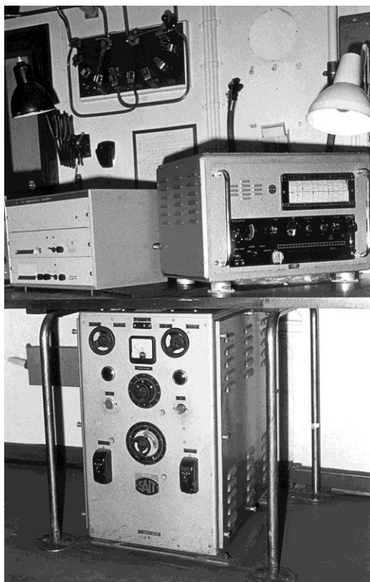
Reine Astrid (nr.1): Boven de VHF duplexzenderontvanger PYE T30FM/R17FM, hoofdtelegrafie-ontvanger Hagenuk UE12. Onderaan de voedingseenheid PS156 voor de hoofdtelegrafiezender SAIT/SBR, EG156.
