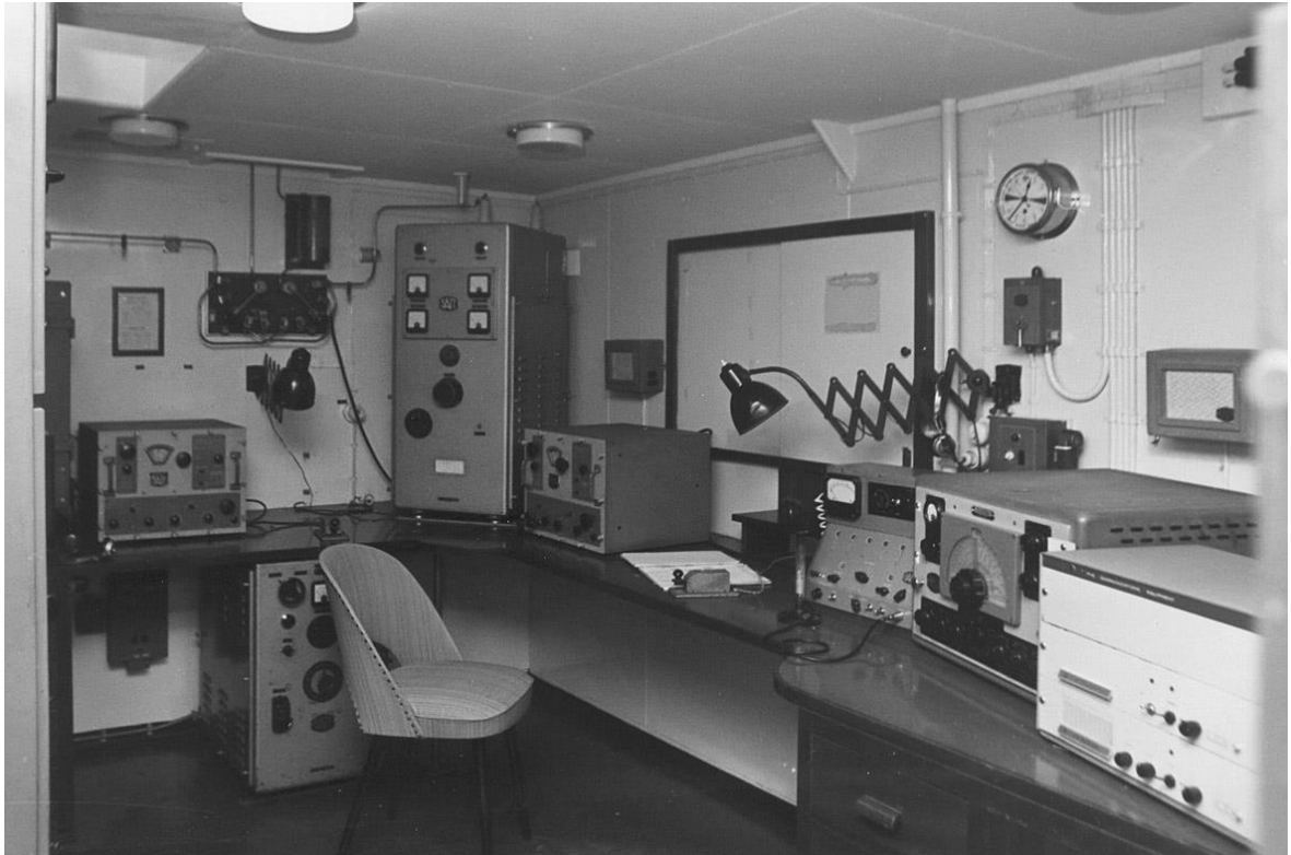
Radiokamer Artevelde. Van l.n.r.: verscholen achter het schakelbord de hulptelegrafiezender EG166 met ontvanger RST155. Onderaan voedingseenheid PS156 voor de hoofdtelegrafiezender EG156 (op de tafel). Verder de hoofdtelegrafieontvanger RT115 en de bedieningsdoos voor EF125 met VHF-omschakelinrichting, telefonie-ontvanger R50M en VHF duplex-zenderontvanger PYE T30FM/R17FM.
