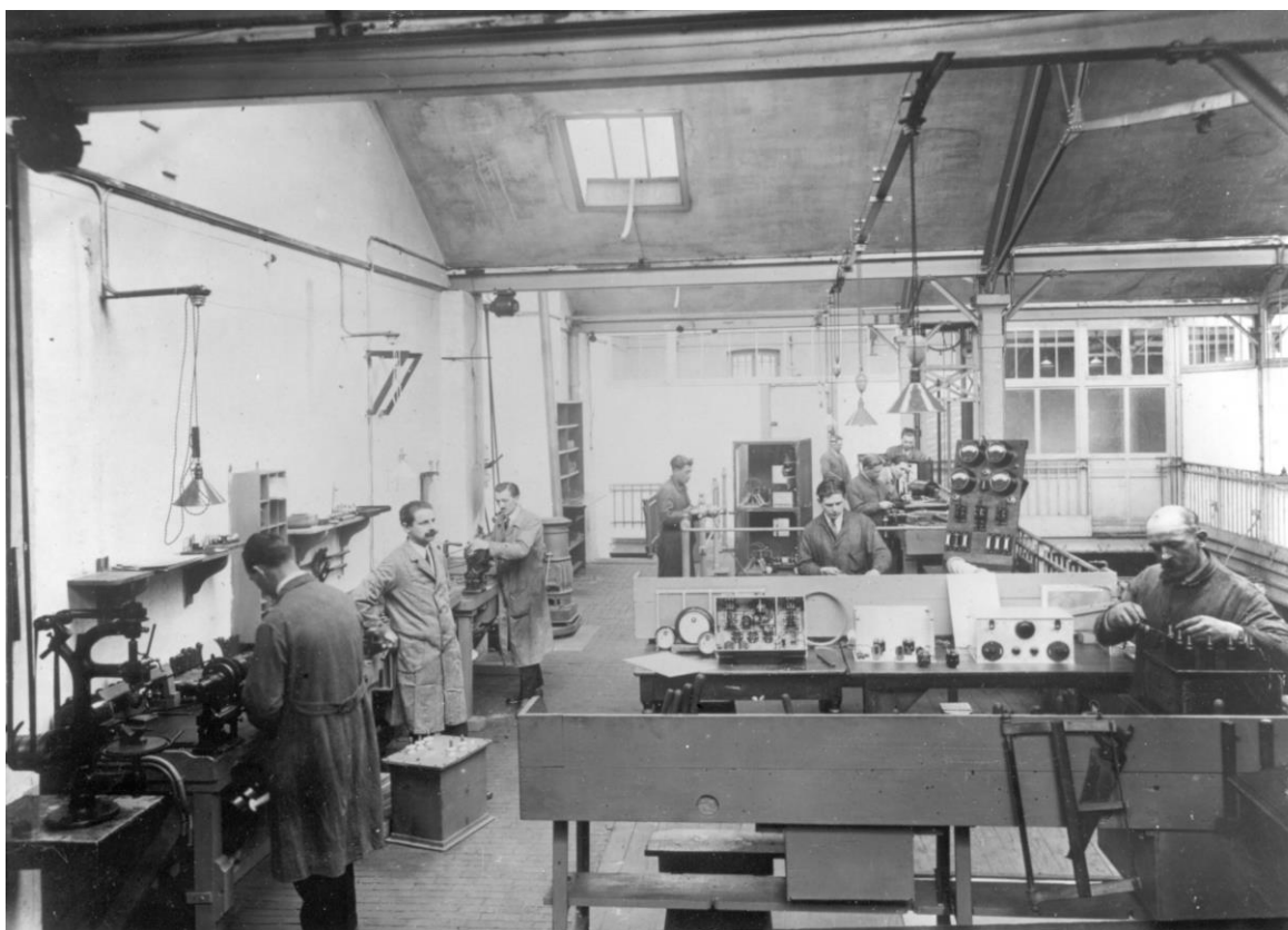
STSF ca. 1925 Deel van de radiowerkplaats. Op de foto herkennen we o.m. onderdelen van een zender met gedempte golven (vonkenzender), een laadbord zoals in gebruik aan boord van de mailboten en een paar radio-ontvangers.
